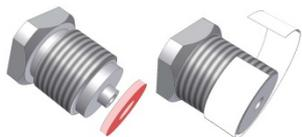
In entrambi i casi, occorre applicare il momento torcente tramite due chiavi, una applicata sulle facce piane dell'attacco al processo dello strumento, e l'altra su quelle della presa di pressione inferiore. **Non**
